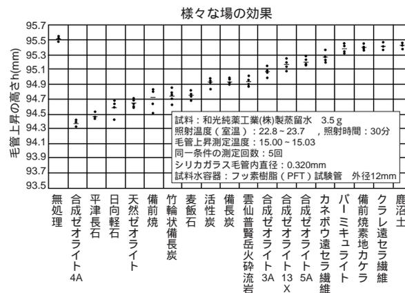
図12 場の作用後の蒸留水の毛管上昇高さ (mm)：項目軸はテフロン (PFA) 試験管を30分間取り巻いた物質名。
